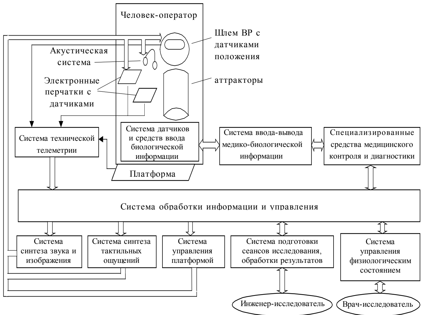
Рис.1. Архитектура комплекса для исследования состояния и деятельности человека-оператора в среде виртуальной реальности
