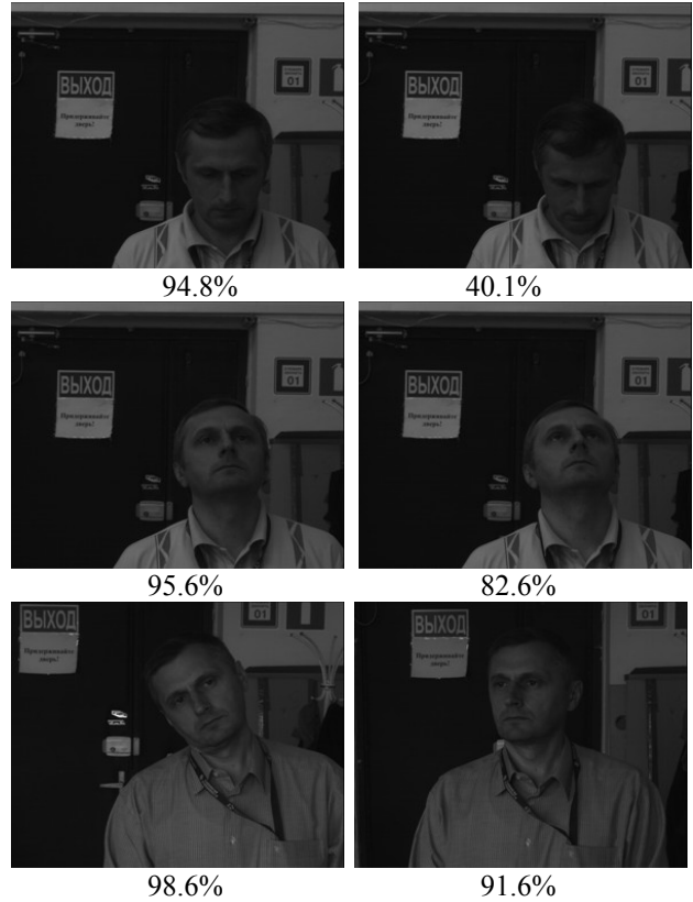
Рис. 7 Мера сходства лица с 3D моделью того же человека, хранимой в базе данных, в зависимости от положения головы.
