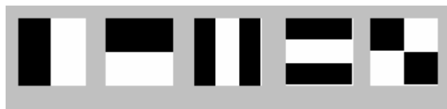
Рис. 2. Фильтры Хаара для выделения характерных признаков номерных знаков.
