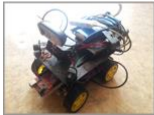
Рис 3.1: Мобильный робот на базе смартфона Efika MX
