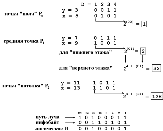
Рисунок 4: Двоичные вычисления при поиске пересеченных подбоксов
