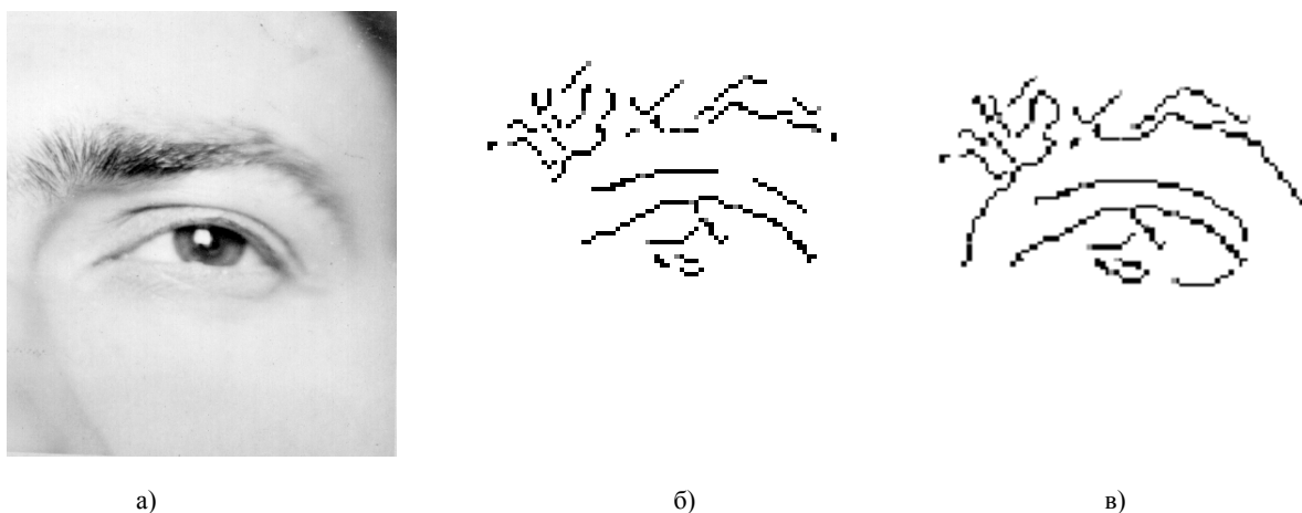
Рис. 3. Отслеживание исчезающих линий с помощью адаптивного метода. а) исходное изображение; б) жесткий порог; в) динамический порог
