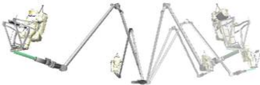
Рис.2. Эксперимент с виртуальной моделью манипулятора ERA: вращение в одном шарнире рысканья фаланги А.
