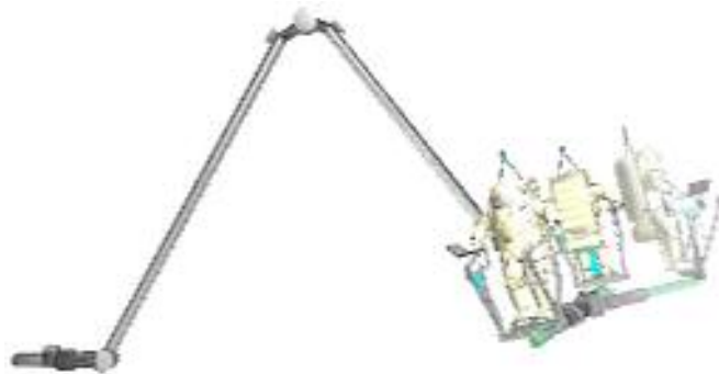
Рис.3. Эксперимент с виртуальной моделью манипулятора ERA: вращение в одном шарнире рысканья фаланги В.
