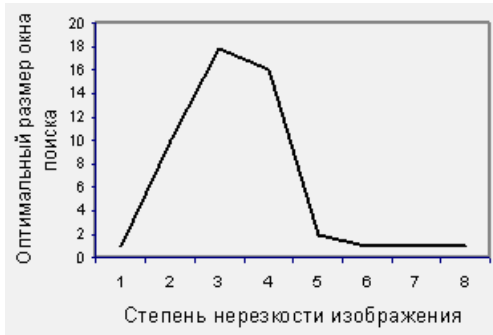
Рисунок 3: Зависимость оптимального размера окна поиска от оценки степени нерезкости изображения
