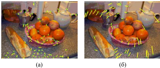
Рисунок 5: Обнаружение соответствий между кадрами до и после дефектного участка при вращательном движении камеры. а - игнорируя дефектные кадры, б – используя оценку модели движения внутри дефектного участка.
