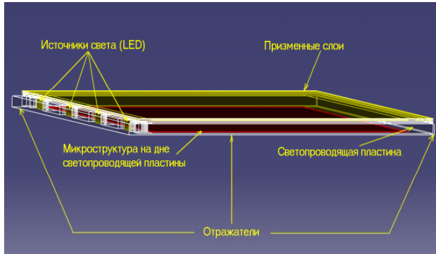
Рис. 6. Осветительная система жидкокристаллического дисплея
