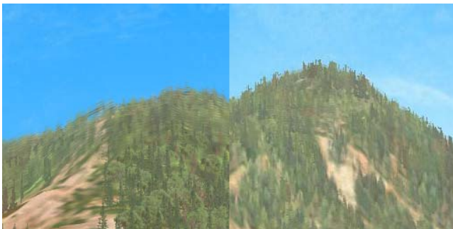
Рис. 4. Слева - артефакты на силуэтах гор. Справа – артефакты на силуэтах гор замаскированы системой вертикальных загоронок.
