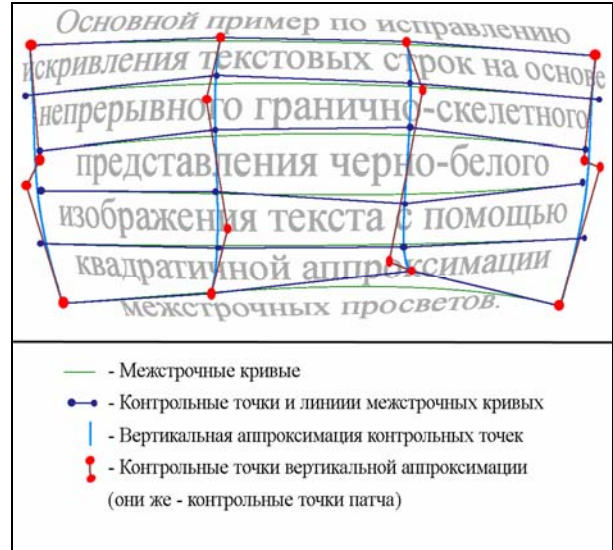
Рис. 5. Пример построения контрольных точек общего патча Безье по набору горизонтальных кривых.
