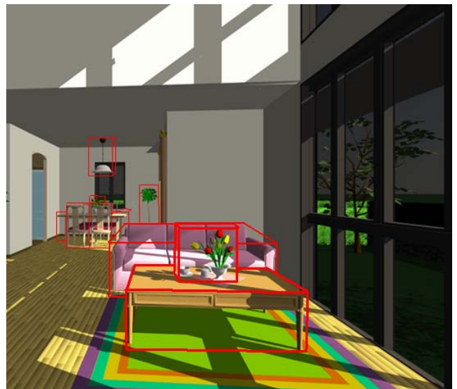
Рис. 2. Организация сцены для двухуровневой трассировки лучей. Красными контурами показаны параллелепипеды, ограничивающие объекты сцены.
