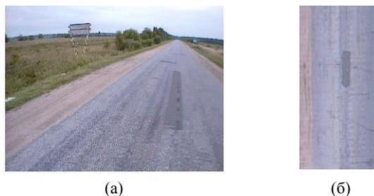
Рисунок 2 Построение развертки дороги. (а) Один из исходных кадров видеосъемки дороги с дорожной лабораторией (б) Полученная развертка дороги
