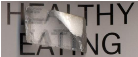
Рис. 1. Двойное лучепреломление в кристалле кальцита 4
