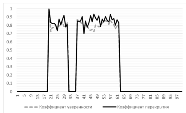
Рис. 3: Зависимости коэффициента уверенности и точности сопровождения от кадра для произвольной видеопоследовательности для TLD (коэфф. корреляции 0.99)
