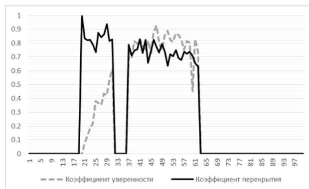
Рис. 4: Зависимости коэффициента уверенности и точности сопровождения от кадра для произвольной видеопоследовательности для СМТ (коэфф. корреляции 0.98)
