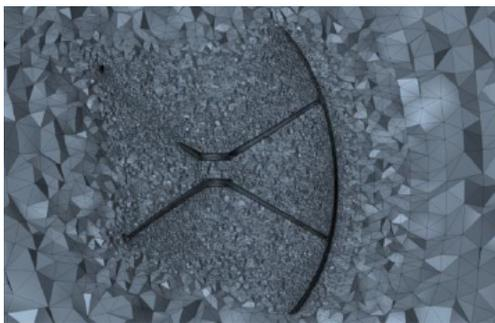
Рис. 1: Общий вид объемной сетки для полной модели узла лопастей
