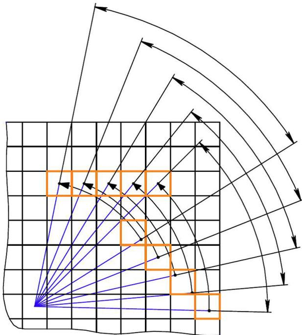
Рис. 1: Последовательное заполнение индексного массива с учетом угла поворота
