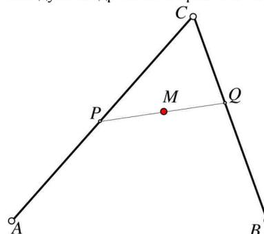
**Рисунок 1:** Геометрическая схема конструирования дуги квадратичной кривой Безье.
