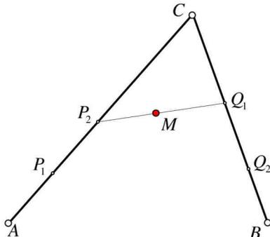
**Рисунок 2:** Геометрическая схема конструирования дуги кривой 2-го порядка гладкости.
