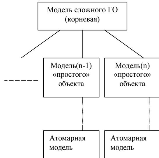
Базируясь на этой модели блок-схему расчленения сложного составного объекта и минимизации связей представим следующим образом:
