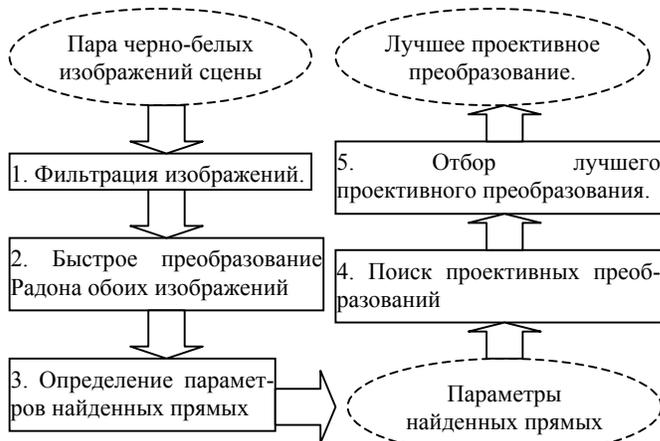
Рис. 1. Алгоритм поиска проективного преобразования, совмещающего изображения
