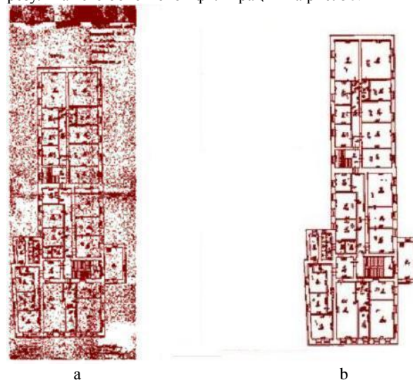
Рисунок 5 а) исходное растровое изображение поэтажного плана здания в штриховом формате, б) результат его фильтрации объектовым фильтром
