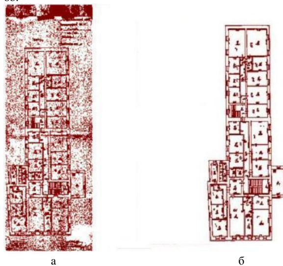
Рисунок 6 а) исходное растровое изображение поэтажного плана здания в штриховом формате, б) результат его фильтрации объектовым фильтром
